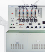
遮断器試験装置
