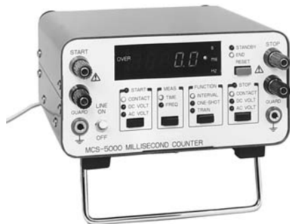
外形寸法 160(W)×90(H)×210(D)mm 約1.2kg
