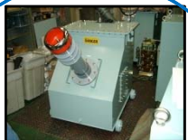
試験用電圧発生トランス 100kV/20kVA
