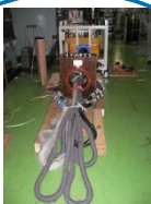
電流発生トランス 2kA/5kVA
