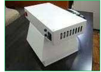
電力量計銘板計量情報読取装置 (OCR-1形)
